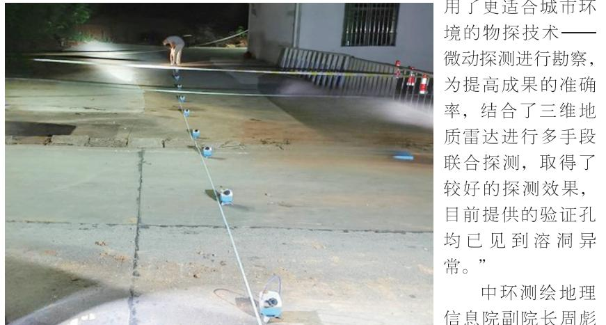
华表示，这次的物探勘察成果能有如此高的准确率要得益于采用了多种物探手段联合进行。众所周知，单一的物探手段具有多解性，为了提高解释的准确性和平定成功率，一般需要采用多种方法组合进行物探勘察。“我们那天晚上十点多接到的任务，在了解了大致情况后，带上了地质雷达和微地震监测仪第一时间赶到了塌陷现场。地质雷达和微动仪都是我们院近几年引进的新设备，特别是微动仪，是今年上半年引进的，它是利用天然噪声进行探测，具有较强的抗干扰性，对野外环境要求不高，适合城市地质调查及地质灾害勘查。”
